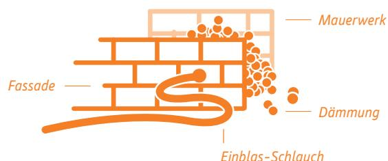
*Hinweis: Wenn Sie planen, ein zusätzliches Fenster o. Ä. einzubauen, machen Sie dies am besten vor Umsetzung der Dämmmaßnahme. Das verhindert ein Herausrieseln des Dämmstoffs beim Öffnen der Fassade.*
