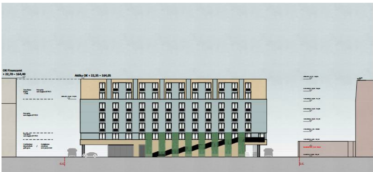
Abb. 42: Vertikale Begrünung der Fluchttreppe – VEP, Ansicht Ost
